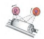
容器を2本のローラー上で回転させながら移動しブラストするタイプと縦吊りしながら移動しタクト運転処理でブラストするタイプがあります。
