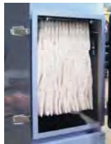
集塵機フィルター
