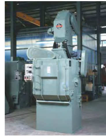
型式：NTF-1 (集塵機：NBF-1) ローター駆動力：3.7kW×1台、70kg/min 容量：50ℓ、150kg 総駆動力：5.25kW バレル寸法：φ500×650L 機械寸法：H2800×W1300×D1160
