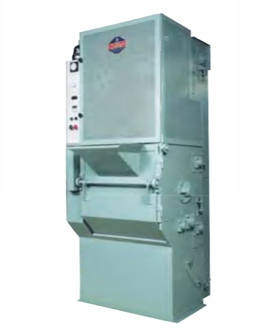
型式：FTF-0P (集塵機一体型) ローター駆動力：3.7kW×1台、150kg/min(MAX) 容量：25ℓ、60kg 総駆動力：4.6kW バレル寸法：φ400×470L 機械寸法：H2300×W930×D1270
