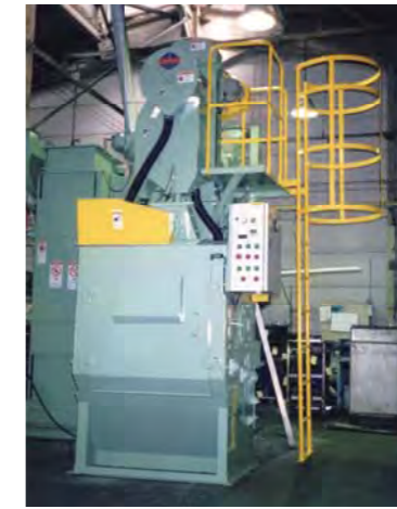
型式：TF-77 (集塵機：NBF-1) ローター駆動力：5.5kW×1台、120kg/min(MAX) 容量：100ℓ、300kg 総駆動力：6.7kW バレル寸法：φ600×800L 機械寸法：H3500×W1430×D1368
