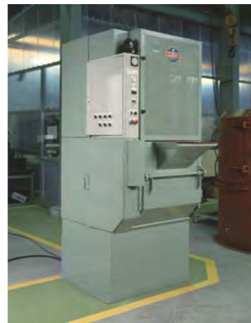
型式：FST-0 (集塵機一体型) ローター駆動力：3.7kW×1台、150kg/min(MAX) 容量：25ℓ、60kg 総駆動力：4.6kW バレル寸法：φ400×500L 機械寸法：H2200×W860×D1290
